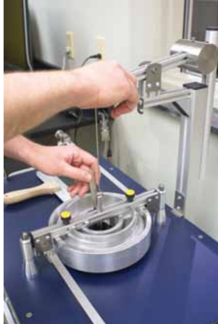
CFI dairesel kesme testi cihazı: dairesel kesme testi cihazı, tozların ve yığın malzemelerin akış özelliklerini ölçmek için kullanılır.
