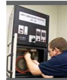
Kuru aşınma test cihazı, konveyör bandı, metal şut astarı ve dökme malzeme arasında olduğu gibi üç cisim sürtünme aşınmasını kontrol eder.
