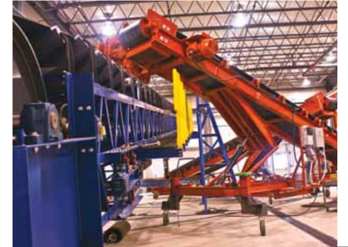
Martin Engineering'in Yenilik merkezinde, proses simülasyonu alanı, malzeme akışı ve bileşen ömrünün gözlemlenmesi için üç bantlı, yeniden dolaşımli bir konveyör döngüsü içeriyor.
